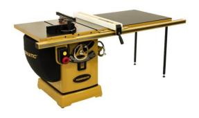
Il est possible d'ajuster la profondeur de coupe en relevant ou en abaissant la lame, et de modifier l'angle de coupe en ajustant l'angle de la lame.
